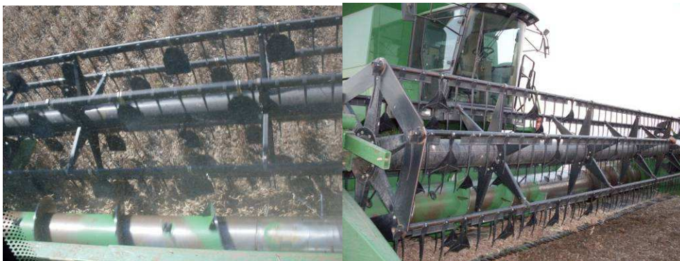
Figura 3: Detalle de paletas de gomas utilizadas colocadas en forma alterna en el molinete.
