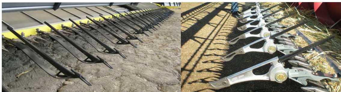
Figura 4: Distintos modelos de levanta mieses desarrollados por la empresa FlexxiFinger de Canadá
