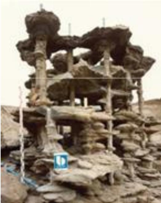
Como se observa en las fotos, esta solución, al vincular las inyecciones con las fundaciones existentes, mejora el suelo y genera un micro-pilote, logrando un mejor resultado. Incluso, hay ocasiones en donde al realizar la intervención se producen levantamientos de la estructura, llegando a un equilibrio entre el peso propio de la estructura y la presión que producen las inyecciones.
